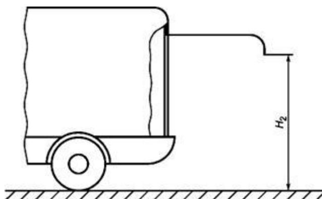
Рисунок 1.6.2. Высота задней двери в открытом положении
