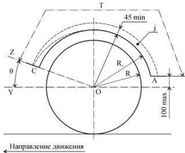
б) Расположение брызговика и энергопоглощающего устройства
