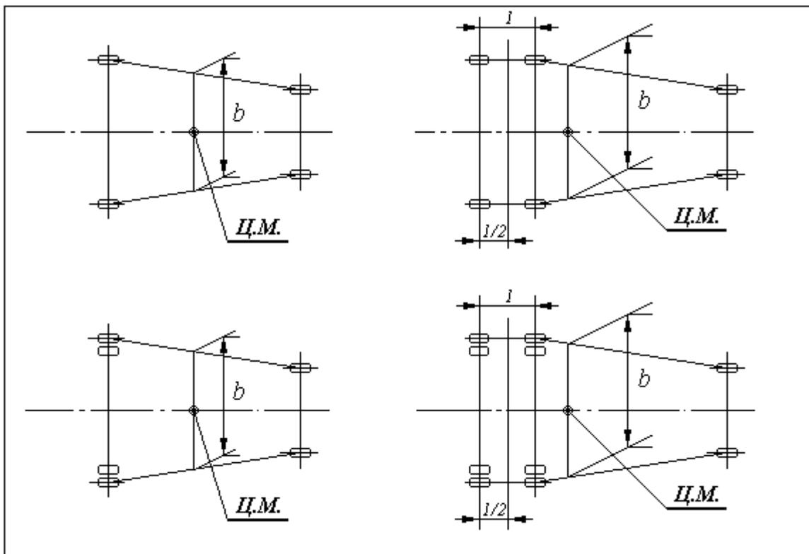
Рисунок 4.1. Схемы определения величины приведенной колеи «b»
