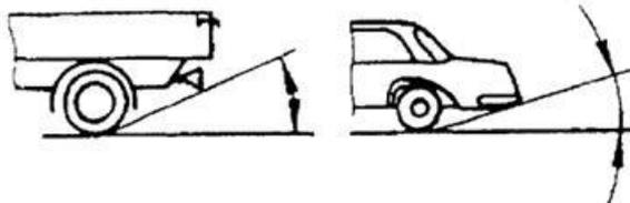
Рисунок 2. Угол съезда
