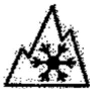
Рисунок 5.1. Маркировка, наносимая на зимнюю шину
