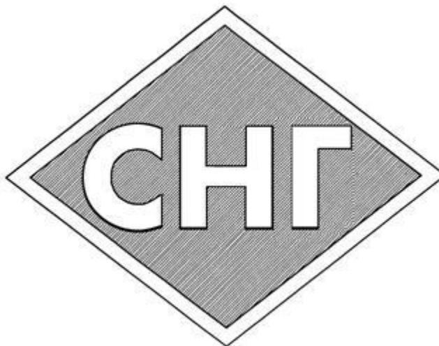
Рисунок 11.1. Образец опознавательного знака для транспортных средств категорий М<sub>2</sub> и М<sub>3</sub>, использующих в качестве топлива сжиженный нефтяной газ (СНГ) или компримированный природный газ (КПГ)
