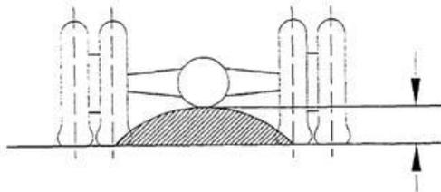
Рисунок 5. Дорожный просвет под одной осью
